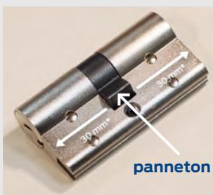
il se mesure en additionnant les longueurs (en mm) de part et d'autre de l'élément central appelé panneton.
