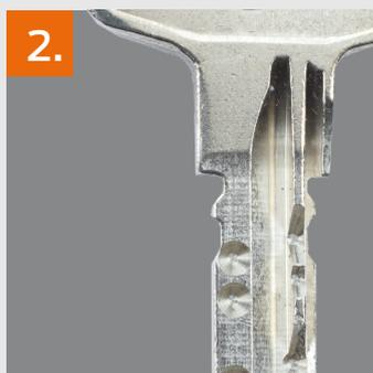
Les clés doivent être remplacées dès les premiers signes d'usure / de torsion liés à leur utilisation pour éviter de détériorer les cylindres.
